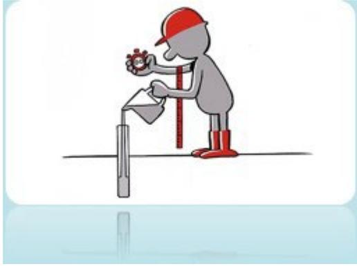
Vous le savez, **l'infiltration des eaux pluviales** est une obligation légale édictée par le Code de l'Eau. Pour s'assurer de la faisabilité de l'infiltration, il est nécessaire de réaliser **un test de perméabilité**. Cela consiste à injecter de l'eau à débit maîtrisé dans un forage (ou un tube piézométrique) et de suivre l'évolution du niveau d'eau au cours du temps.
