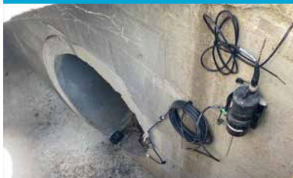
En 2022, ce sont 25 déversoirs d'orage, principalement implantés en amont des zones de baignade, qui ont été équipés de sondes de détection de surverse. Volumes, débits rejetés ou encore localisation des surverses sont autant de paramètres mesurés et contrôlés par nos équipes ! Intensifier la surveillance de ces ouvrages est primordiale pour préserver la qualité des eaux de baignade.
